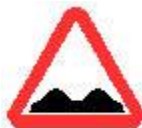
1.17 "Искусственная неровность". Участок дороги с искусственной неровностью (неровностями) для принудительного снижения скорости.
